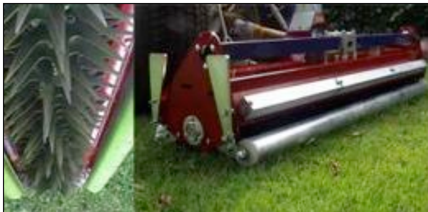
Maredo TT 2116 –vibratähti-ilmastin
